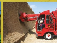
Obsah sušiny siláže, odebrané ze silážního žlabu, měří NIRs přístroj namontovaný za fezaččinu vybírače.
