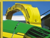
Obsah sušiny sklizené píce měří NIRs přístroj HarvestLab, namontovaný přímo na fezačku.
