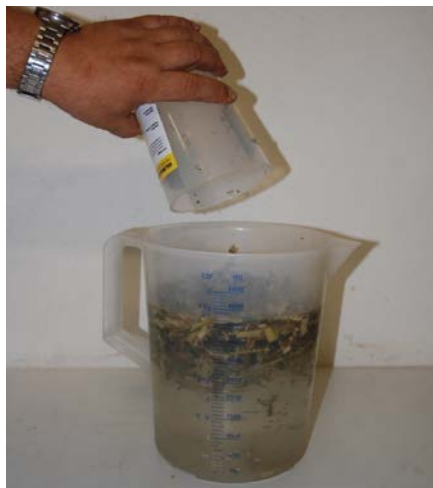
Obr. 4 – Mokrá separace vzorku kukuřičné siláže
