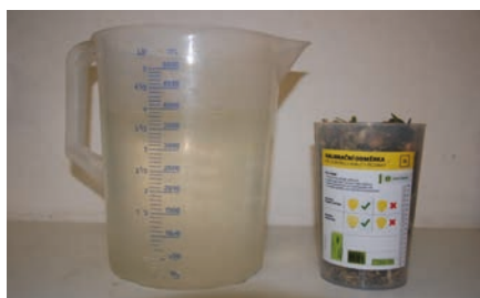
Obr. 3 – Příprava vzorku kukuřičné siláže k mokré separaci zrna siláže
