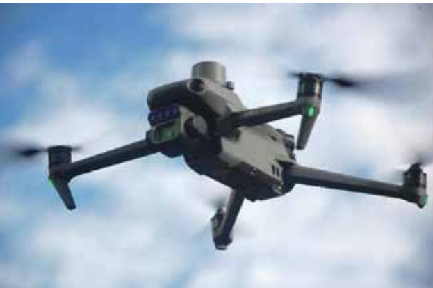
Obrázek 1: Bepilotní letoun DJI Mavic 3M
