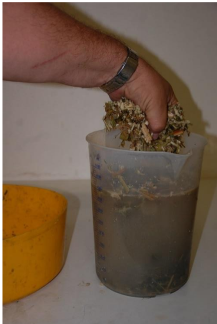
Obrázek 1: Oddělení vrchní vrstvy siláže (rostlinná část siláže) od zrna, které je na dně nádoby
