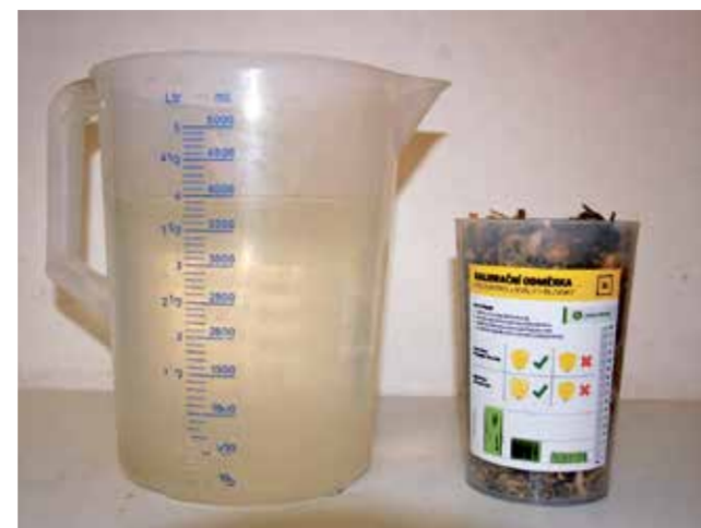
Obr. 5 Příprava vzorku kukuřičné siláže k mokré separaci zrna siláže.
