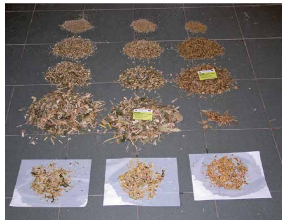
Obr. 4 Separace PSPS a narušení zrna mokrou cestou u vzorků 1, 2 a 3.
