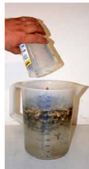
Obr. 6 Mokrá separace vzorku kukuřičné siláže
