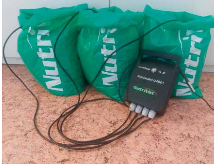
Obr. 3: Průběh měření stability siláže přístrojem NutriStabil
